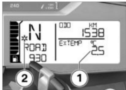
Σε εξωτερικές θερμοκρασίες κάτω από 3 °C υπάρχει κίνδυνος σχηματισμού πάγου. Όταν η θερμοκρασία μειωθεί για πρώτη φορά σε αυτό το επίπεδο, εμφανίζεται αυτόματα, ανεξάρτητα από τη ρύθμιση της οθόνης, η ένδειξη εξωτερικής θερμοκρασίας **1**, η εμφανιζόμενη τιμή αναβοσβήνει.
