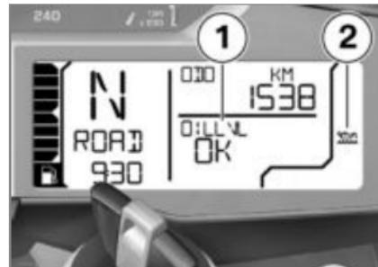
Η υπόδειξη στάθμης λαδιού **1** δίνει πληροφορίες σχετικά με τη στάθμη λαδιού στον κινητήρα. Η ένδειξη αυτή μπορεί να κληθεί μόνο σε σταματημένη μοτοσικλέτα.
