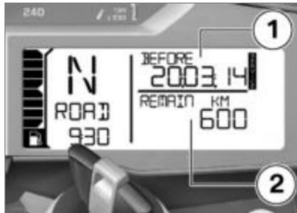
Εάν ο υπολειπόμενος χρόνος μέχρι το επόμενο σέρβις ανέρχεται σε λιγότερο από ένα μήνα ή το επόμενο σέρβις πρέπει να γίνει εντός 1000 km, εμφανίζεται για λίγο η ημερομηνία του σέρβις **1** και τα υπολειπόμενα χιλιόμετρα **2** μετά τον έλεγχο Pre-Ride-Check.
