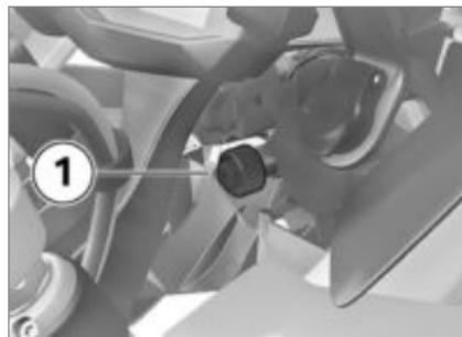
Если при высокой нагрузке регулировки предварительного натяжения пружины недостаточно для защиты встречного транспорта от ослепления:
