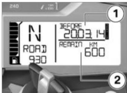
Если до следующего ТО осталось менее месяца или менее 1000 км, то после завершения проверки Pre-Ride-Check на короткое время на дисплей выводится дата ТО **1** и оставшийся пробег **2**.
