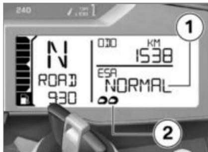
Жесткость амортизатора отображается на многофункциональном дисплее в поле **1**, а
