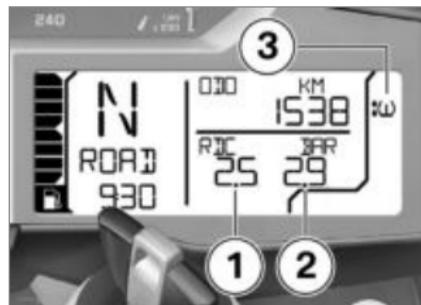
Левое значение **1** отображает давление воздуха в шине переднего колеса, а правое значение **2** - давление воздуха в шине заднего колеса. Сразу после включения зажигания отображается "-- --". Передача значений давления в шинах начинается только после первого превышения значения скорости 30 км/ч. Отображаемые значения давления в шинах справедливы при температуре воздуха в шинах 20 °C.
