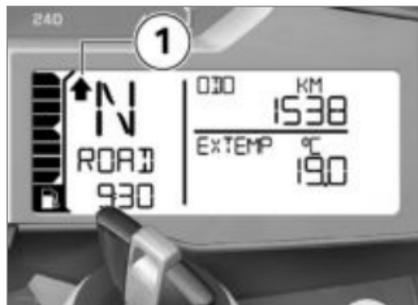
Рекомендация повышения передачи **1** сигнализирует оптимальный момент включения повышающей передачи для обеспечения экономичного расхода.
