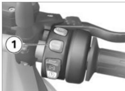
⚠ Режим бездорожья (Enduro и Enduro Pro) не предназначен для движения по обычным дорогам. Включение режима бездорожья (Enduro и Enduro Pro) при движении по дороге может приводить к нестабильной работе системы ABS (при торможении), а также системы ASC (при ускорении). Это может стать причиной падения мотоцикла. Включать режим бездорожья (Enduro и Enduro Pro) только при движении по бездорожью.◀
