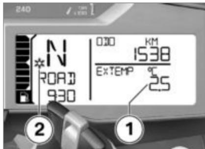
При наружных температурах ниже 3 °C существует опасность гололеда. При первом понижении температуры ниже этого значения на дисплей не-
