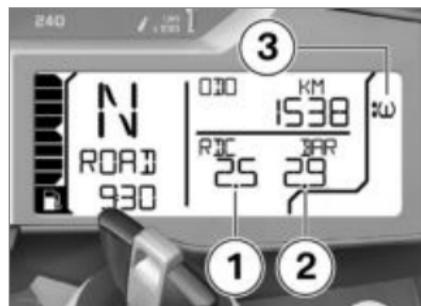
El valor de la izquierda **1** representa la presión de inflado de la rueda delantera, y el de la derecha **2**, el de la rueda trasera. Inmediatamente después de conectar el encendido aparece "-- --". La transmisión de los valores de presión de inflado comienza una vez sobrepasada por primera vez una velocidad de 30 km/h. Las presiones de inflado de los neumáticos indicadas hacen referencia a una temperatura del aire de los neumáticos de 20 °C.
