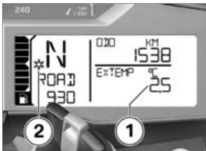
Con temperaturas exteriores inferiores a 3 °C existe el riesgo de formación de hielo. En el momento en el que esta temperatura no se supera, independientemente del ajuste de la pantalla, se cambia automáticamente a la visualización de la pantalla **1**, y el valor visualizado parpadea.
