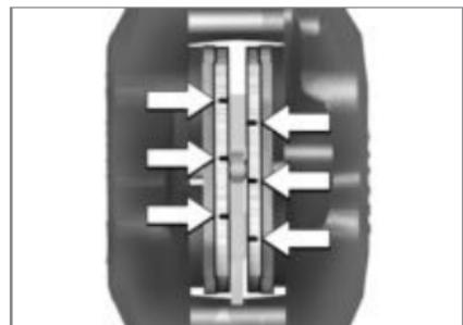
Граница на износване на спирачните накладки отпред
