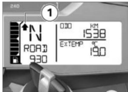
Препоръката за превключване на по-висока-скорост **1** сигнализира за икономически най-подходящия момент за превключване към по-висока скорост.
