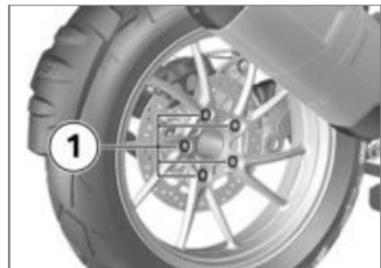
**!** Дължините на колесните болтове на колелото със спици и лятата джанта са различни. Смесването или размяната на колесните болтове води до дефектно закрепване на задното колело и по този начин до опасност от злополука.
