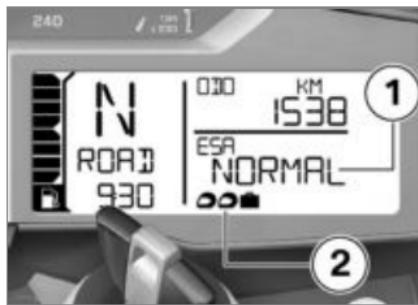
Амортизорът се изобразява на многофункционалния дисплей в участъка **1**, а предвари-
