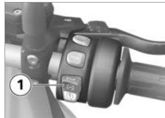
1 Interruptor de emergência
