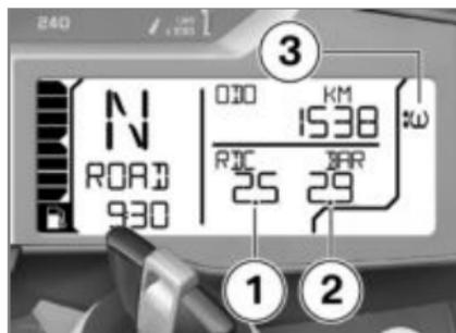
Левое значение **1** отображает давление воздуха в шине переднего колеса, а правое значение **2** - давление воздуха в шине заднего колеса. Сразу после включения зажигания отображается "-- --". Передача значений давления в шинах начинается только после первого превышения значения скорости 30 км/ч. Отображаемые значения давления в шинах справедливы при температуре воздуха в шинах 20 °С.
