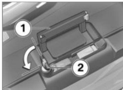
**⚠** При складывании ручки для переноски, если замок кофра стоит вдоль направления движения, можно повредить фиксирующую лапку. Перед складыванием ручки для переноски обратите внимание на то, чтобы замок кофра стоял поперек направления движения.◀
