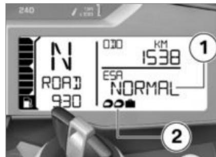
Жесткость амортизатора отображается на многофункциональном дисплее в поле **1**, а предварительное натяжение пружины – в поле **2**.
