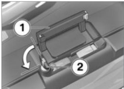
**⚠** При складывании ручки для переноски, если замок кофра стоит вдоль направления движения, можно повредить фиксирующую лапку. Перед складыванием ручки для переноски обратите внимание на то, чтобы замок кофра стоял поперек направления движения. ◀
