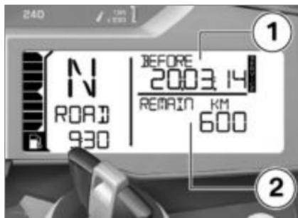
Если до следующего ТО осталось менее месяца или менее 1000 км пробега, после завершения проверки Pre-Ride-Check на короткое время на дисплей выводится дата ТО **1** и оставшийся пробег **2**.
