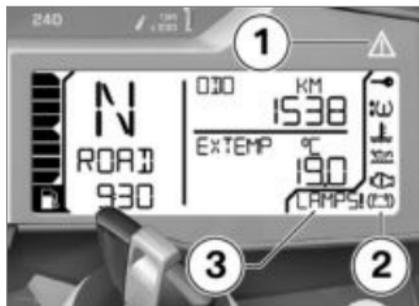
Предупреждения, для которых не предусмотрены отдельные сигнальные лампы, показываются с помощью общей сигнальной лампы **1** в сочетании с предупреждающим символом в поле **2** или предупреждающим указанием в поле **3**. В зависимости от степени важности предупреждения общая
