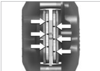
前部制动摩擦片磨损极限
