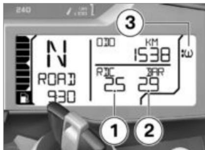
Il valore di sinistra **1** indica la pressione di gonfiaggio della ruota anteriore, il valore di destra **2** la pressione di gonfiaggio della ruota posteriore. Subito dopo l'inserimento dell'accensione viene visualizzato "-- --". La trasmissione dei valori della pressione pneumatici inizia dopo aver prima superato una velocità di 30 km/h. Le pressioni di gonfiaggio visualizzate si riferiscono a una temperatura dell'aria interna dei pneumatici di 20 °C.
