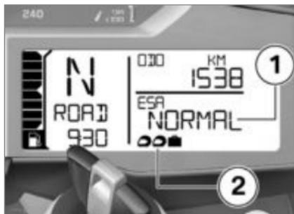
L'ammortizzazione viene visualizzata sul display multifunzione nel campo **1**, il precarico molle nel campo **2**.
