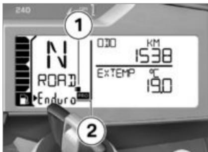
Il simbolo **1** del connettore di codifica viene visualizzato sul di-
