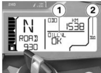
Η υπόδειξη στάθμης λαδιού **1** δίνει πληροφορίες σχετικά με τη στάθμη λαδιού στον κινητήρα. Η ένδειξη αυτή μπορεί να κληθεί μόνο σε σταματημένη μοτοσυκλέτα.
