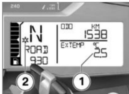
Σε εξωτερικές θερμοκρασίες κάτω από 3 °C υπάρχει κίνδυνος σχηματισμού πάγου. Όταν η θερμοκρασία μειωθεί για πρώτη φορά σε αυτό το επίπεδο, εμφανίζεται αυτόματα, ανεξάρτητα από τη ρύθμιση της οθόνης, η ένδειξη εξωτερικής θερμοκρασίας **1**, η εμφανιζόμενη τιμή αναβοσβήνει.
