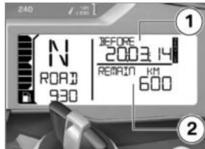
Εάν ο υπολειπόμενος χρόνος μέχρι το επόμενο σέρβις ανέρχεται σε λιγότερο από ένα μήνα ή το επόμενο σέρβις πρέπει να γίνει εντός 1000 km, εμφανίζεται για λίγο η ημερομηνία του σέρβις **1** και τα υπολειπόμενα χιλιόμετρα **2** μετά τον έλεγχο Pre-Ride-Check.
