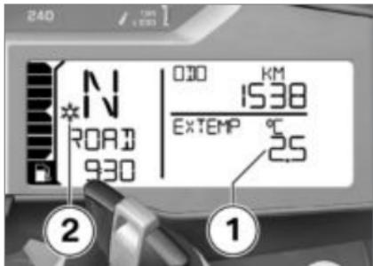
При наружных температурах ниже 3 °C существует опасность гололеда. При первом понижении температуры ниже этого значения на дисплей независимо от настройки автоматически выводится показание наружной температуры **1**, отображаемое значение мигает.
