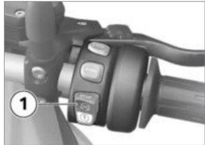
**1** Экстренный выключатель зажигания
