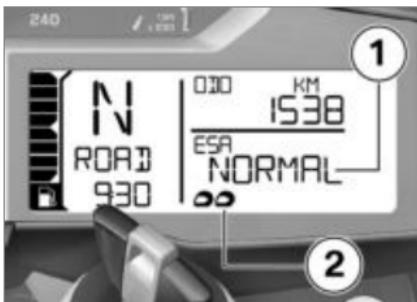
Жесткость амортизатора ото-
