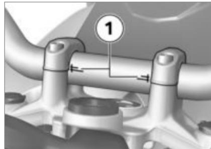
Наклон руля мотоцикла регулируется в пределах маркировки **1**. Для регулировки руля обратитесь на СТО, лучше всего к официальному дилеру BMW Motorrad.
