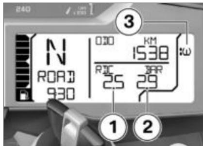
Левое значение **1** отображает давление воздуха вшине переднего колеса, а правое значение **2** — давление воздуха вшине заднего колеса. Сразу после включения зажигания отображается -- -. Передача значений давления в шинах начинается только после первого превышения значения скорости 30 км/ч. Отображаемые значения давления в шинах справедливы при температуре воздуха в шинах 20 °С.
