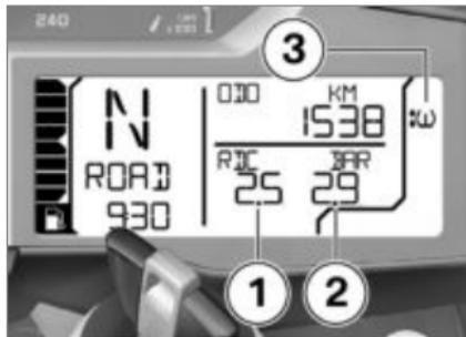
Il valore di sinistra **1** indica la pressione di gonfiaggio della ruota anteriore, il valore di destra **2** la pressione di gonfiaggio della ruota posteriore. Subito dopo l'accensione del quadro viene visualizzato "- -". La trasmissione dei valori della pressione pneumatici inizia dopo aver superato una prima volta la velocità di 30 km/h. Le pressioni
