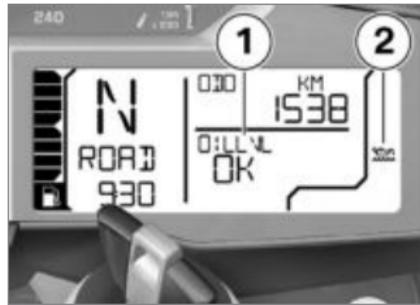
L'avvertimento del livello dell'olio **1** fornisce informazioni sul livello dell'olio nel motore. Tale indicazione può essere richiamata solo a veicolo fermo.
