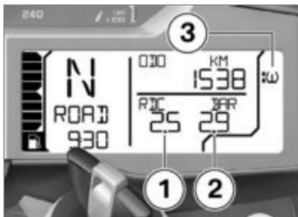
El valor de la izquierda **1** representa la presión de inflado de la rueda delantera, y el de la derecha **2**, el de la rueda trasera. Inmediatamente después de conectar el encendido se muestra «-- --». La transmisión de los valores de presión de inflado comienza una vez sobrepasada por primera vez una velocidad de 30 km/h. Las presiones de inflado de los neumáticos indicadas hacen referencia a una temperatura del aire de los neumáticos de 20 °C.
