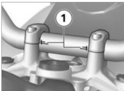
Se puede regular la inclinación del manillar de la motocicleta en las zonas de la marca **1**. Para el ajuste del manillar, acuda a un taller especializado, preferentemente a un Concesionario BMW Motorrad.
