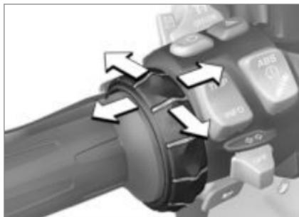
El control del Multi-Controller se realiza con seis movimientos:
