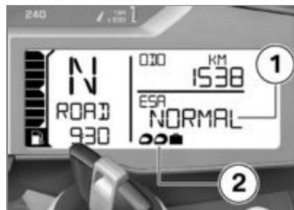
Амортизорът се изобразява на многофункционалния дисплей в участъка **1**, а предварителното напрягане на пружината - в участък **2**.
