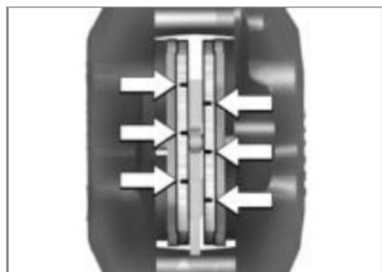
Граница на износване на спирачните накладки отпред
