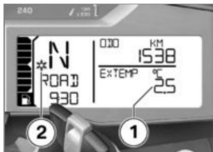
При външни температури под 3 °C съществува опасност от образуване на поледица. При падане на температурата под тази граница, независимо от настройката на дисплея, се превключва автоматично на индикатора за външна температура 1, индикираната стойност мига.
