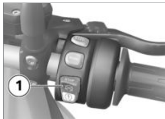
1 Interruptor de emergência
