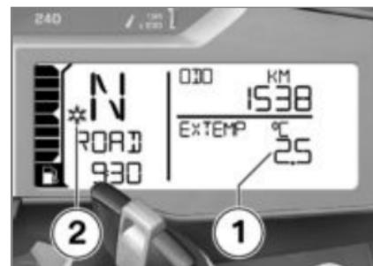
При наружных температурах ниже 3 °C существует опасность гололеда. При первом понижении температуры ниже этого значения на дисплей не-
