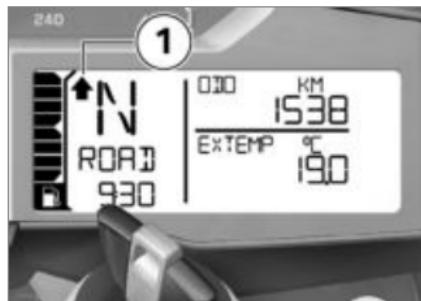
Рекомендация повышения передачи **1** сигнализирует оптимальный момент включения повышающей передачи для обеспечения экономичного расхода.
