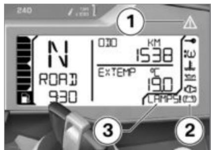
Предупреждения, для которых не предусмотрены отдельные сигнальные лампы, показываются с помощью общей сигнальной лампы **1** в сочетании с предупреждающим символом в поле **2** или предупреждающим указанием в поле **3**. В зависимости от степени важности предупреждения общая
