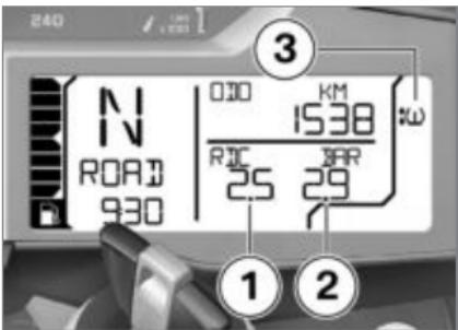
Левое значение **1** отображает давление воздуха в шине переднего колеса, а правое значение **2** - давление воздуха в шине заднего колеса. Сразу после включения зажигания отображается "-- --". Передача значений давления в шинах начинается только после первого превышения значения скорости 30 км/ч. Отображаемые значения давления в шинах справедливы при температуре воздуха в шинах 20 °C.
