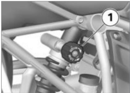
**!** Настройка предварительного натяжения пружины, не согласованная с настройкой амортизатора, ухудшает динамические показатели мотоцикла.
