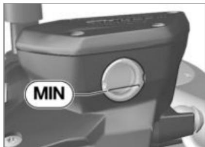
Уровень тормозной жидкости в переднем контуре
