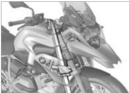
**!** Можно повредить детали. Не зажимать узлы, такие как, например, трубопроводы тормозного привода или стренги кабеля.◀
