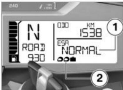
El ajuste de la amortiguación se indica en la pantalla multifunción, en la zona **1**, y el pretensado del muelle, en la zona **2**.
