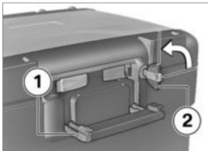
**!** Si se pliega el asa de transporte cuando la cerradura de la Topcase esté en posición horizontal, se puede dañar la lengüeta de cierre.
