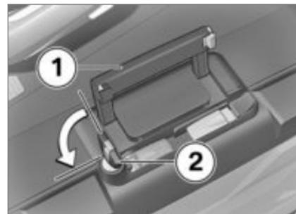
**!** Si se cierra el asa de transporte cuando la cerradura de la maleta esté paralela a la dirección de la marcha, se puede dañar la lengüeta de cierre. Antes de cerrar el asa de transporte observar que la cerradura de la maleta esté transversal a la dirección de la marcha.◀
