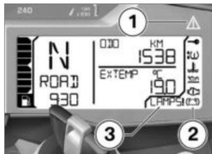
Las advertencias para las que no se dispone de un testigo de aviso propio, se muestran con un testigo de aviso general **1** en combinación con un símbolo de advertencia en la zona **2**, o con una indicación de advertencia en la zona **3**. En función de la urgencia de la advertencia, el tes-
