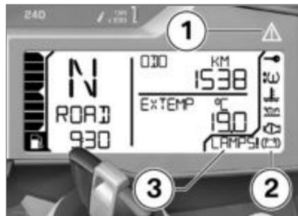
Opozorila, za katera ni posebnih opozorilnih lučk, so prikazana s splošno opozorilno lučko **1** v povezavi z opozorilnim simbolom na položaju **2** ali opozorilom na položaju **3**. Odvisno od nujnosti opozorila se prižge rdeča ali rumena splošna opozorilna lučka. Splošna opozorilna lučka se prižge skladno z najnujnejšim opozorilom.
