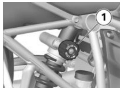
**⚠** Настройка предварительного сжатия пружины, не согласованная со степенью демпфирования, ухудшает динамические показатели мотоцикла.
