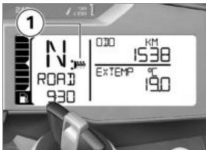
Ручки руля имеют два уровня обогрева. Установленная ступень отображается на многофункциональном дисплее на позиции **1**.
