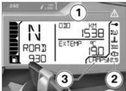
Предупреждения, для которых не предусмотрены отдельные сигнальные лампы, показываются с помощью общей сигнальной лампы **1** в сочетании с предупреждающим символом в поле **2** или предупреждающим указанием в поле **3**. В зависимости от степени важ-
