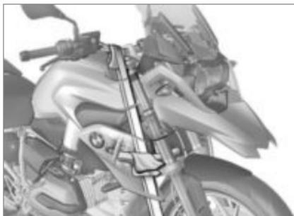
**!** Можно повредить детали. Не пережимать такие детали как трубопроводы тормозного привода или стренги кабелей. ◀
