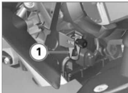
Другой способ быстрой регулировки угла наклона фар - с помощью поворотного рычага.
