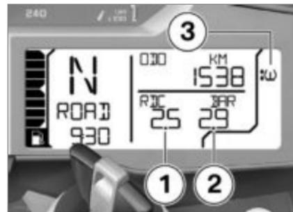
Отображаемые значения давления воздуха в шинах пересчитываются применительно к температуре воздуха в шинах 20 °C. Левое значение **1** отображает давление воздуха в шине переднего колеса, а правое значение **2** - давление воздуха в шине заднего колеса. Непосредственно после включения зажигания отображается
