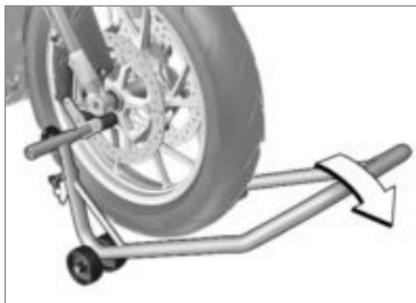
**!** Мотоцикл установлен на подставке: если приподнять переднюю часть мотоцикла слишком высоко, то подставка оторвется от земли и мотоцикл может опрокинуться. При приподнимании следить, чтобы подставка не отрывалась от земли. ◀
