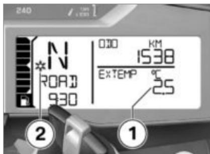
При наружных температурах ниже 3 °C существует опасность гололеда. При первом понижении температуры ниже этого значения на дисплей независимо от настройки автоматически выводится показание наружной температуры **1**, отображаемое значение мигает.
