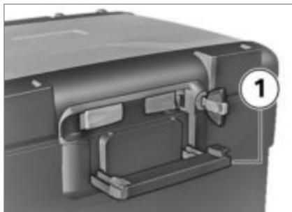
**!** При складывании ручки для переноски, если замок топкейса стоит горизонтально, можно повредить фиксирующую лапку.
