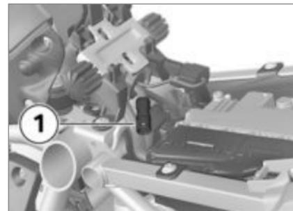
**⚠** В открытый штекер может попасть грязь и влага, что приводит к нарушению функционирования. После снятия кодера установить обратно защитный колпачок.◀
