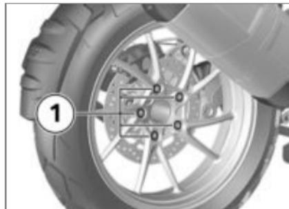
**!** Длина колесных болтов для спицевого колеса и литого колесного диска отличается. Установка разных или неподходящих по длине колесных болтов ведет к неудовлетворительному креплению заднего колеса и может стать причиной аварии.
