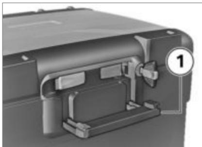
**!** При складывании ручки для переноски, если замок топкейса стоит горизонтально, можно повредить фиксирующую лапку. Перед складыванием ручки для переноски обратите внимание на то, чтобы замок топкейса стоял вертикально. ◀
