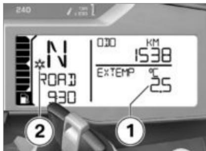
In caso di temperature esterne sotto ai 3 °C esiste il pericolo della formazione di ghiaccio. La prima volta che si raggiungono valori inferiori a questa temperatura indipendentemente dall'impostazione del display si passa automaticamente all'indicazione della temperatura esterna **1**, il valore indicato lampeggia.
