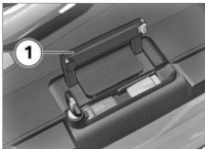
**!** Se si abbassa la maniglia di sostegno quando la serratura della valigia è longitudinale rispetto al senso di marcia, è possibile danneggiare la linguetta di bloccaggio.
