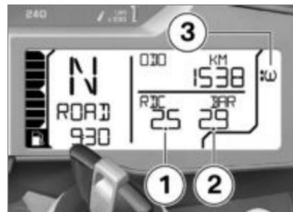
La pressione di gonfiaggio indicata si riferisce ad una temperatura degli pneumatici di 20 °C. Il valore di sinistra **1** indica la pressione di gonfiaggio della ruota anteriore, il valore di destra **2** la pressione di gonfiaggio della ruota posteriore. Subito dopo l'inserimento dell'accensione viene visualizzato -- -- poiché il trasferimento delle pressioni pneumatici inizia solo ad una velocità superiore ai 30 km/h.
