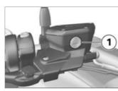
Comprobar el nivel de líquido de frenos en el depósito delantero 1.
