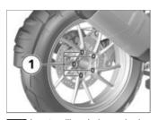
Los tornillos de la rueda de radios y de la llanta de fundición tienen longitudes diferentes. Para garantizar una fijación segura de la rueda trasera y minimizar el riesgo de accidentes, evitar mezclar o intercambiar los tornillos de rueda.
