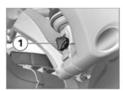
• Girar el tornillo de ajuste 1 en el sentido de las agujas del reloi para aumentar la amortiquación.
