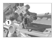
Puede entrar suciedad y humedad en el conector abierto y dar lugar a fallos de funcionamiento
