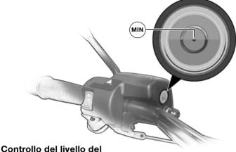
Controllo del livello del liquido nel comando della frizione
