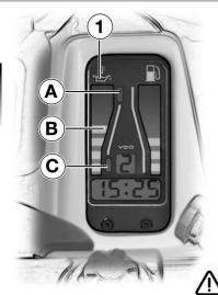
Il display d'informazioni del guidatore è pronto per il funzionamento solo con accensione inserita.
