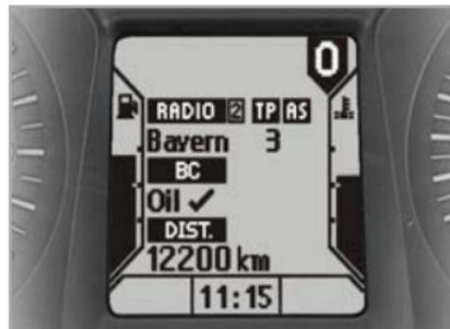
L'indicatore "olio" segnala il livello dell'olio presente nel motore. Per il controllo del livello dell'olio devono essere soddisfatte le seguenti condizioni:
