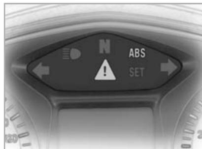
Le spie ABS vengono visualizzate da una combinazione tra spia di avvertimento generale e spia di avvertimento ABS. Le due spie di avvertimento possono restare accese o lampeggiare 1 o 4 volte al secondo.
