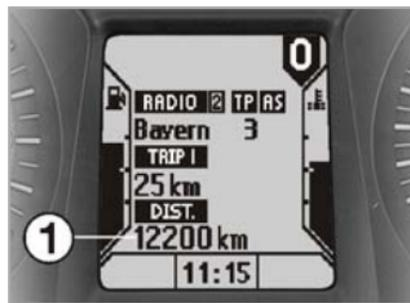
Il chilometraggio totale viene visualizzato nel settore **1** del display.
