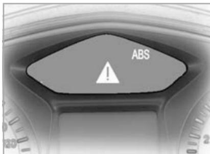
L'efficienza del BMW Integral ABS viene controllata con l'autodiagnosi e il test di avviamento (►► 71). L'autodiagnosi viene effettuata automaticamente dopo l'inserimento dell'accensione.
