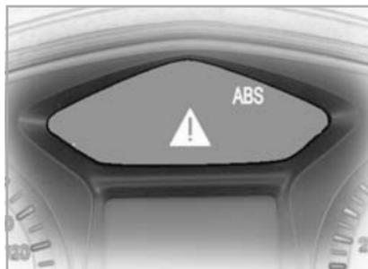
Die Funktionsbereitschaft des BMW Integral ABS wird durch die Eigendiagnose und den Anfahrtest (➡ 71) überprüft. Die Eigendiagnose erfolgt automatisch nach Einschalten der Zündung.
