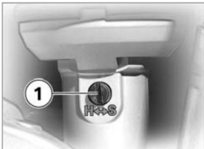
Zur Verstärkung der Dämpfung:
