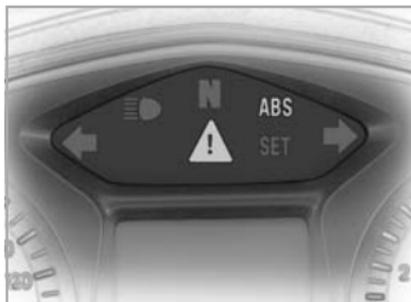
ABS-Warnungen werden durch die Kombination aus Warnleuchte Allgemein und Warnleuchte ABS angezeigt. Beide Warnleuchten können dauerhaft leuchten oder 1x oder 4x pro Sekunde blinken.
