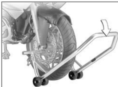
**!** Con la motocicleta sobre el caballete central: si el vehículo se levanta demasiado por delante, el caballete central se levanta del suelo y la motocicleta puede volcar hacia un lado.
