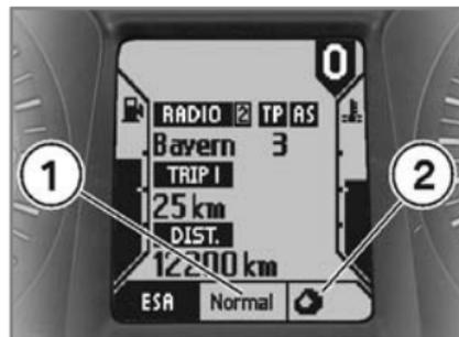
Con ayuda del electrónico del tren de rodaje ESA es posible adaptar el vehículo de forma cómoda a las diferentes condiciones de la marcha.
