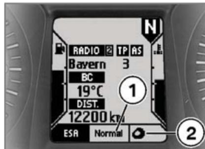
Mit Hilfe der elektronischen Fahrwerkseinstellung ESA können Sie Ihr Fahrzeug komfortabel an unterschiedliche Fahrbedingungen anpassen. Drei Federvorspannungen können mit drei Dämpfungseinstellungen kombiniert werden, um das Fahrzeug optimal an die Beladung und den Untergrund anzupassen. Die Dämpfungseinstellung
