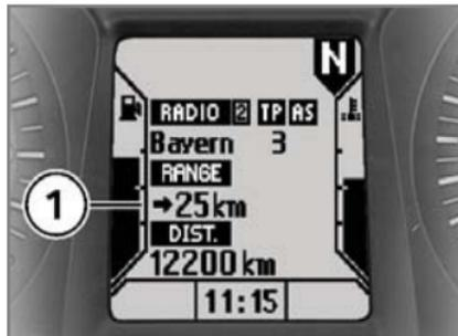
Die Restreichweite **1** gibt an, welche Strecke mit dem verbleibenden Kraftstoff noch gefahren werden kann. Sie wird bei Fahrzeugen ohne Bordcomputer nur nach Erreichen der Kraftstoffreserve angezeigt. Die Berechnung
