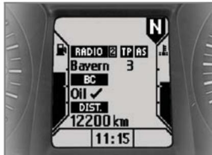
Die Anzeige "Oil" gibt Auskunft über den Ölstand im Motor. Sie kann nur bei Fahrzeugstillstand aufgerufen werden.
