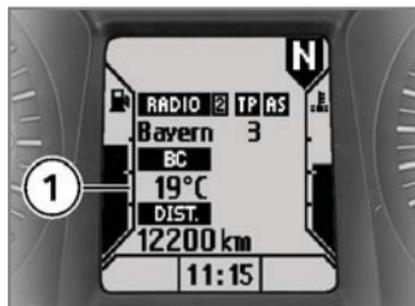
Die Darstellung der Umgebungstemperatur **1** ist nur bei laufendem Motor aktiv, ansonsten wird -- angezeigt.
