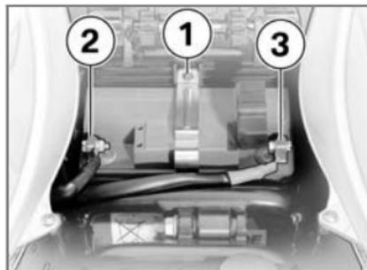
Falsche Trennreihenfolge erhöht das Kurzschlussrisiko.
