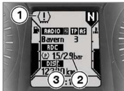
In der oberen Displayzeile werden der Luftdruck des Vorderrades **3** und der Luftdruck des Hinterrades **2** mit dem Warnsymbol **1** angezeigt. Der kritische Luftdruck blinkt. Liegt der kritische Wert im Grenzbereich der zulässigen Toleranz, leuchtet zusätzlich die Warnleuchte Allgemein gelb. Liegt der ermittelte Rei-
