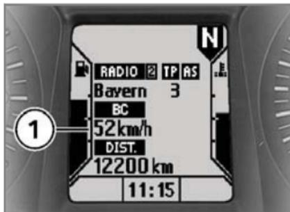
Bei der Berechnung des Durchschnittsverbrauchs **1** wird die seit dem letzten "RESET" verbrauchte Kraftstoffmenge mit den seitdem gefahrenen Kilometern verrechnet.
