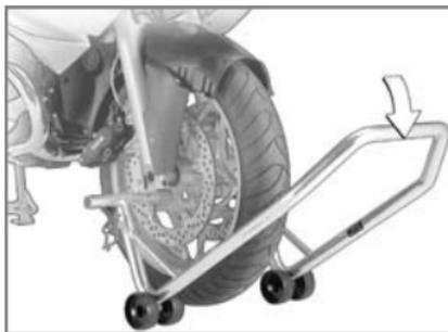
**!** Steht das Motorrad auf dem Kippständer: Wird das Motorrad vorn zu weit angehoben, hebt der Kippständer vom Boden ab und das Motorrad kann zur Seite kippen. Beim Anheben darauf achten, dass der Kippständer auf dem Boden bleibt. ◀
