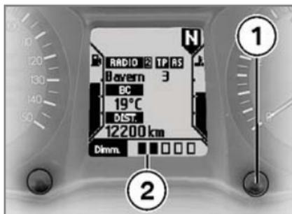
**!** Das Einstellen der Dimmung während der Fahrt kann zu Unfällen führen. Dimmung nur bei stehendem Motorrad einstellen. ◀
