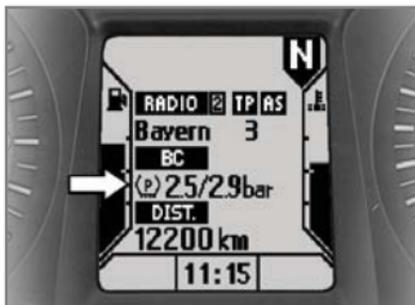
Die Reifenluftdrücke werden als zusätzlicher Wert des Bordcomputers angezeigt. Der linke Wert stellt den Luft-
