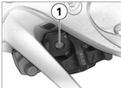
Le disque de frein ne doit pas être visible à travers le trou **1** de la plaquette intérieure. Si le disque de frein est visible :
