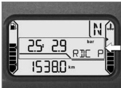
Las presiones de inflado de los neumáticos se muestran con la inscripción RDC P. El valor de la izquierda representa la presión de inflado de la rueda delantera, y el de la derecha, la de la rueda trasera. Inmediatamente después de conectar el encendido aparece -- --, ya que la transmisión de los valores de presión de inflado comienza a partir de una velocidad de 30 km/h.
