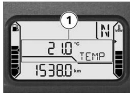
Con el vehículo parado, el calor del motor puede provocar una medición incorrecta de la temperatura ambiente 1. Si la influencia del calor del motor es muy grande, la pantalla muestra -- durante un momento.
