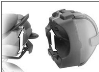
Si una de las maletas se moviera o resultara difícil colocarla, debe adaptarse a la distancia entre los alojamientos inferior y superior. Para ello puede modificarse la altura del soporte inferior de la maleta.
