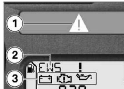
Los avisos se representan mediante el testigo de advertencia general **1** en combinación con una indicación de advertencia, como p. ej., **2** o con uno de los símbolos de advertencia **3**. En función de la urgencia de la advertencia, el testigo de advertencia general se ilumina en rojo o en amarillo. Si hay varias advertencias, se muestran todos los testigos y símbolos de advertencia correspondientes, las
