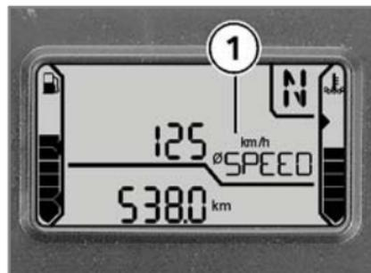
Bei der Berechnung der Durchschnittsgeschwindigkeit **1** wird die seit dem letzten "RESET" verstrichene Zeit zugrunde gelegt. Nicht berücksichtigt werden Fahrtunterbrechungen, bei denen der Motor abgestellt wurde.
