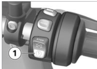
1 Ārkārtas izslēgšanas slēdzis
