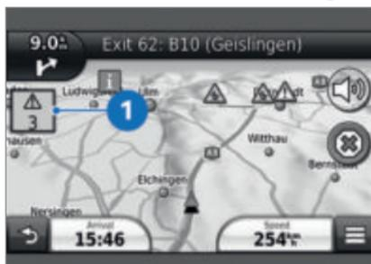
Kontroll- und Warnmeldungen des Motorrads werden mit einem entsprechenden Symbol **1** links oben auf der Kartensicht angezeigt.
