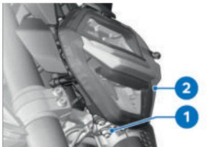
Reicht bei hoher Zuladung die Anpassung der Federvorspannung nicht aus, um den Gegenverkehr nicht zu blenden:
