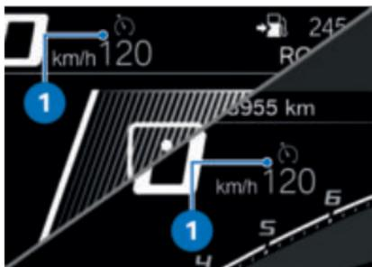
Das Symbol **1** für die Geschwindigkeitsregelung wird in der Ansicht Pure Ride und in der oberen Statuszeile angezeigt.
