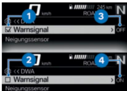
Einigen Menüpunkten ist ein Kästchen vorangestellt. Das Kästchen zeigt an, ob die Funktion ein- oder ausgeschaltet ist. Aktionssymbole nach den Menüpunkten veranschaulichen, was durch kurzes Kippen des Multi-Controllers nach rechts geschaltet wird.
