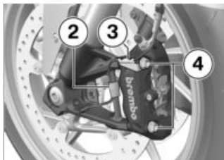
制动钳安装到伸缩套筒叉上
