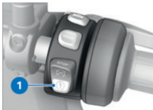
1 Interruptor de emergência
