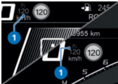
정속주행장치용 기호 1이 Pure Ride 보기 및 상부 상태 표시 줄에 표시됩니다.
