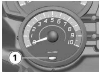
Der Drehzahlwarner signalisiert dem Fahrer das Erreichen des roten Drehzahlbereichs. Dieses Signal wird durch das Blinken des Drehzahlwarners **1** in rot dargestellt.
