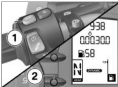
Um die Stoppuhr während der Fahrt (als Laptimer) besser bedienen zu können, können die Funktionen der Taste INFO **1** und die Funktionen der Taste **2** getauscht werden. Die Bedienung der Stoppuhr und der Tageskilometerzähler erfolgt dann über die Taste INFO **1**, der Bordcomputer muss über die Taste **2** bedient werden.
