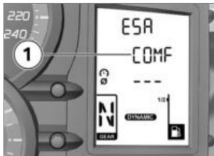
Die eingestellte Dämpfung wird im Multifunktionsdisplay im Be-
