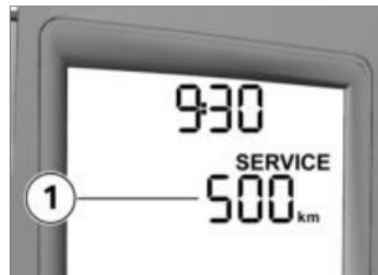
Bei hohen Jahreskilometerleistungen kann es unter Umständen vorkommen, dass ein vorgezogener Service fällig wird. Liegt der Kilometerstand für den vorgezogenen Service innerhalb von 1000 km, werden die verbleibenden Kilometer **1** in 100-km-Schritten heruntergezählt. Sie werden im Anschluss an den Pre-Ride-Check für kurze Zeit angezeigt.
