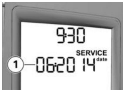
Liegt die verbleibende Zeit bis zum nächsten Service innerhalb eines Monats, wird das Servicedatum **1** für kurze Zeit im Anschluss an den Pre-Ride-Check angezeigt. Monat und Jahr werden getrennt durch einen Doppelpunkt 2- bzw. 4-stellig dargestellt. In diesem Beispiel bedeutet die Anzeige "Juni 2014".
