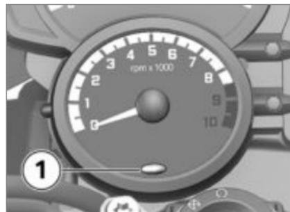
Die Drehzahlwarnung signalisiert dem Fahrer das Erreichen des roten Drehzahlbereichs. Dieses Signal wird durch das Blinken der Kontrollleuchte **1** in rot dargestellt.
