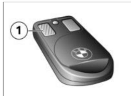
Soll die Alarmfunktion aktiviert werden, nachdem nach Ausschalten der Zündung mehr als eine Minute vergangen ist, muss die Taste **1** länger als eine Sekunde betätigt werden. Nach ca. einer Stunde im deaktivierten Zustand schaltet sich die DWA zur Schonung der Batterie aus. Zur Aktivierung der Alarmfunktion nach diesem Zeitraum muss die Zündung ein- und wieder ausgeschaltet werden.
