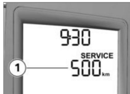
Bei hohen Jahreskilometerleistungen kann es unter Umständen vorkommen, dass ein vorgezogener Service fällig wird. Liegt der Kilometerstand für den vorgezogenen Service innerhalb von 1000 km (700 mls), werden die verbleibenden Kilometer **1** in 100-km-Schritten (100 mls) heruntergezählt. Sie werden im Anschluss an den Pre-Ride-Check für kurze Zeit angezeigt.
