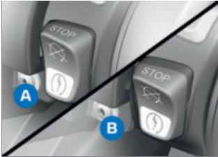
A الدفع الكهربائي متوقف
