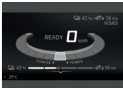
Der E-Scooter ist fahrbereit, wenn beim Betätigen der Bremse die Startertaste gedrückt wird. Die Antriebsanzeige wird sichtbar und **READY** wird angezeigt. Alle Systeme sind betriebsbereit. Durch das Drücken des Not-Aus-Schalters ist der E-Scooter nicht mehr fahrbereit.
