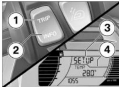
SETUP **3** ist gestartet. Die Trennlinie **4** ist ausgeblendet.
