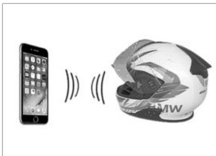
A cada casco con sistema de comunicación se le puede asignar un teléfono propio, pero un teléfono solo puede asignarse a un sistema de comunicación.
