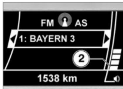
Während die Lautstärke eingestellt wird, wird die Skala **2** angezeigt. Wird die Lautstärke nicht mehr verändert, wird die Anzeige automatisch ausgeblendet.
